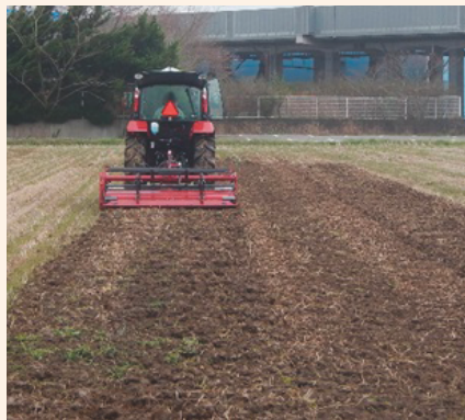
写真1 自動操舵補助装置を使用した耕うん状態（測位方式：DGNSS）
