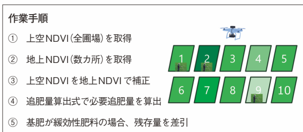
図3 ドローンデータの補正による新たな水稻生育診断・追肥量算出システムの作業手順
