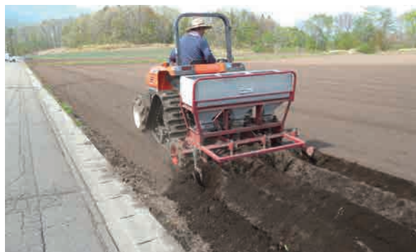
嬭恋のうね立て同時施肥機はうね間が狭いのが特徴。 耕うん、施肥、うね立てが同時にできる。
