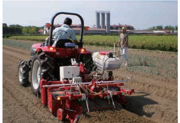
写真2 ペースト局所施肥機 HPST-4(三菱農機) 片倉チッカリン(株)提供
