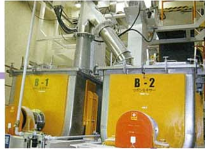
④混合 投入された原料をミキサーで混合します。
