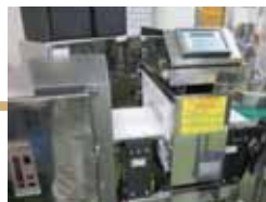
④金属探知機・重量チェッカー 異物混入対策/計量ミス対策です。
