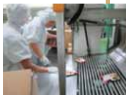
⑥除水 レトルト殺菌した製品に付着した水分に風を当てて除去しています。
