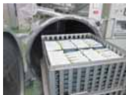
⑤レトルト殺菌 1つ1つ充填された鍋スープをレトルト殺菌用のトレイに並べ、レトルト殺菌釜へ投入しています。
