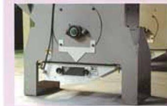
残留米排出装置 (コンタミ対策)
