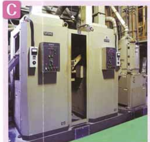
精米機(研削、摩擦、摩擦)
