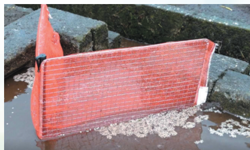
プラスチック被膜殻の水田圃場からの流出防止捕集ネットの検証
