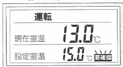
<ノズルヒータ異常の表示>
