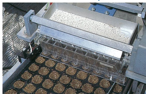
⑤自動播種機(各セルに1粒ずつ種子落下)
