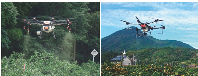
写真1 農薬散布用ドローン 左：「AGRAS MG-1」、右：「AGRAS T-20」(T-20は自動航行可能)
