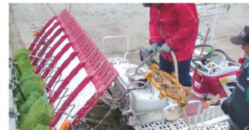
雨でも施肥・田植えが可能 ポンプでの肥料補給で、らくらく
