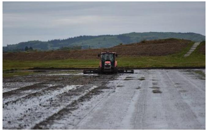
G P S 自動操舵付きトラクターでの代かき作業
