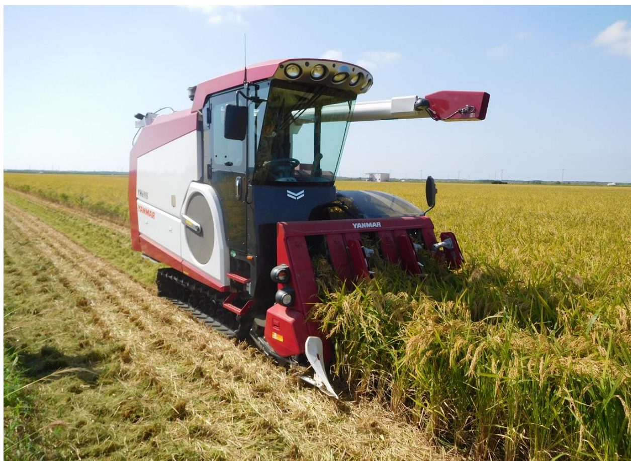
収穫しながら収量を測定・Webサイトで収量分析もできるコンバインでの収穫
