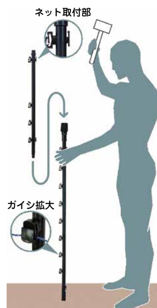
図2：支柱設置イメージ
