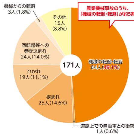
令和3年の1年間で発生した農業作業死亡事故は242件、そのうち農業機械作業に係る事故は171件(約70%)、さらにそのうち機械の転倒・転落での事故が約50%を占めています。
