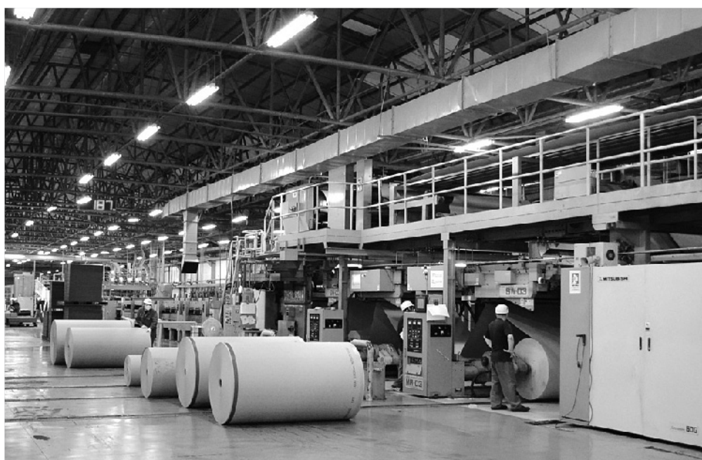
▲段ボール工場内部＝原紙から板シートを製造するコルゲートマシン
