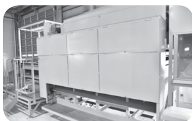
② 根切機・除泥機
