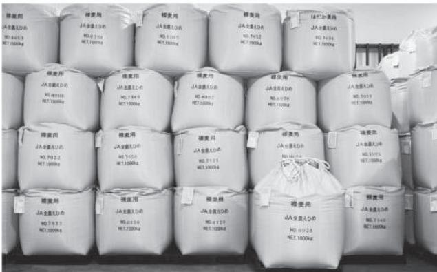
1 t のフレコンを3段+目止めの計4段積みで保管。
