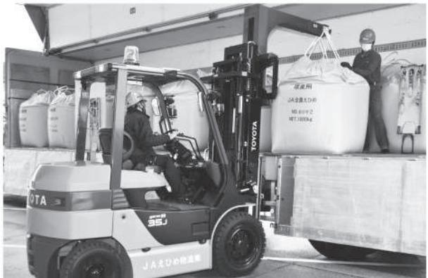
専用のアタッチメントを装備したフォークリフトを導入。フレコンの搬入・搬出に使用する。
