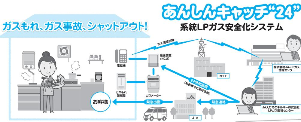
ガスを監視して、24時間、JAのLPガス集中監視システムの安心機能。
