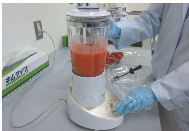
写真2 残留農薬を検査するため農産物を粉碎している様子
