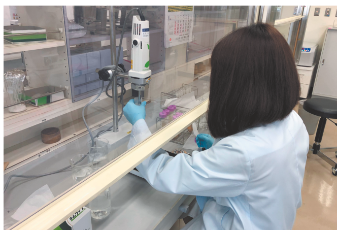
写真3 残留農薬を検査するため農薬成分を抽出している様子
