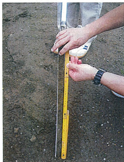
④指で押して土層の厚さを調べます。硬盤層の位置、厚さ、下層の水分状況等を確認します。
