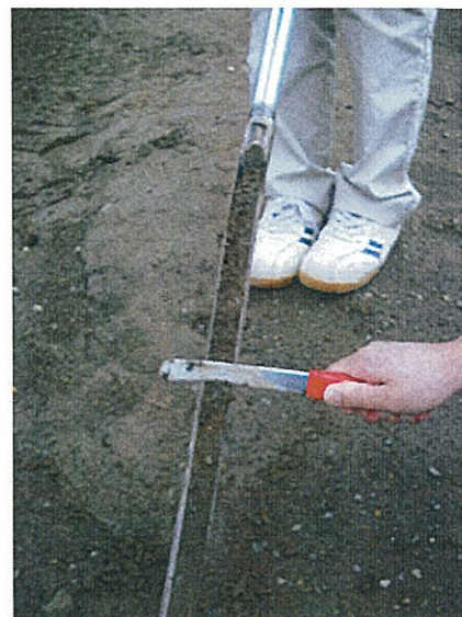
③ハンドルを1周回し、引き抜きます。切り取られた土層をヘラで整形し、断面を観察します。
