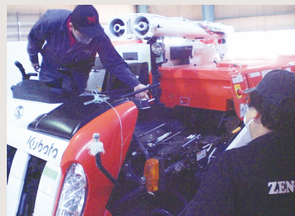
こぎ深さ自動の作動確認（2級コンバイン）
