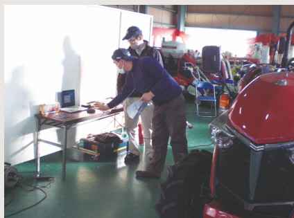
パソコンを使用した故障診断（1級トラクタ）
