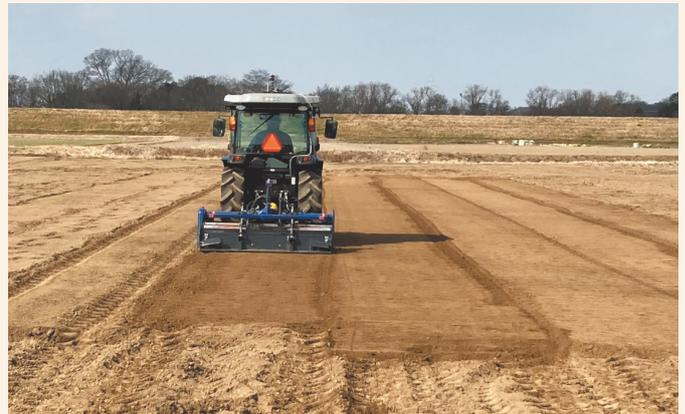
写真2 自動操舵補助装置を使用した耕うん状態 (DGNSS)
