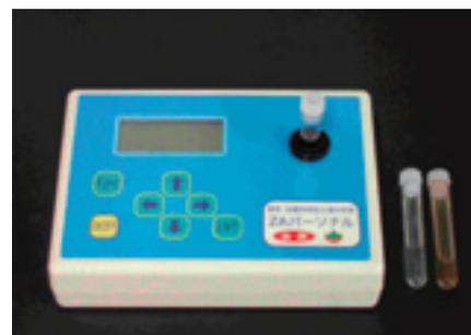
写真-2 比色計本体と試験管(セル)
