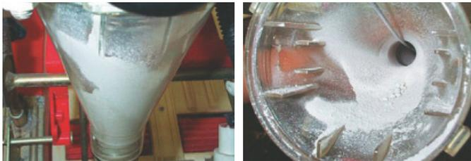
写真-3 側条施肥田植機の肥料付着の例
