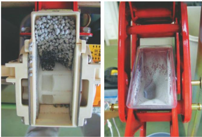
吸湿による線出し部への肥料の付着 シュート部への肥料粉状物の付着
