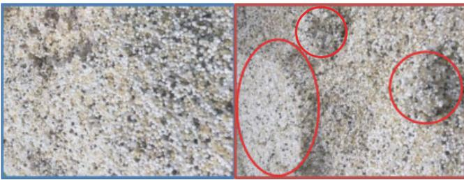
写真-3 固結堆積試験開封時の様子(左:タルク添加区、右:無処理区)
