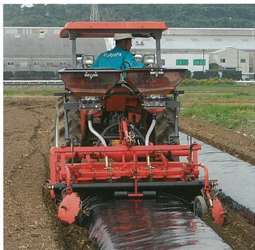
写真3 うね内施肥同時マルチ機 (株)クボタ提供
