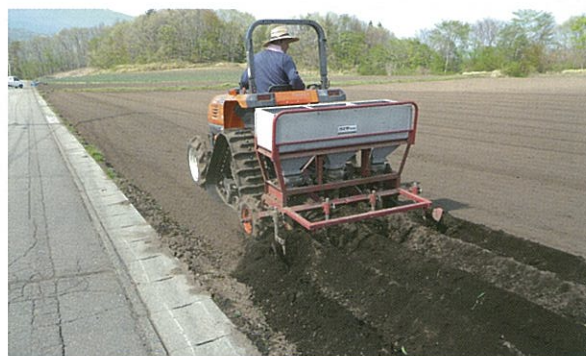
婦恋のうね立て同時施肥機はうね間が狭いのが特徴。 耕うん、施肥、うね立てが同時にできる。
