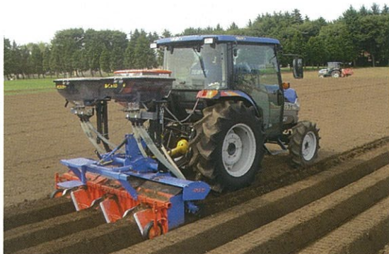
写真1 うね内部分施肥機(イセキ「エコうねまぜ君」) (独)農研機構 中央農業総合研究センター・屋代幹雄氏提供
