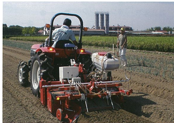
写真2 ペースト局所施肥機 HPST-4 (三菱農機) 片倉チッカリン(株)提供
