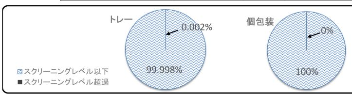
スクリーニング法に準拠した検査機で測定 しており、スクリーニングレベル(50Bq/kg)以 下であれば基準値(100Bq/kg)よりも確実に低 いと判別されます。
