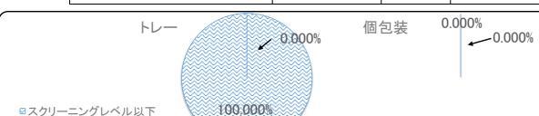
スクリーニング法に準拠した検査機で測定しており、スクリーニングレベル(50Bq/kg)以下であれば基準値(100Bq/kg)よりも確実に低いと判別されます。
