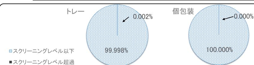
スクリーニング法に準拠した検査機で測定しており、スクリーニングレベル(50Bq/kg)以下であれば基準値(100Bq/kg)よりも確実に低いと判別されます。
