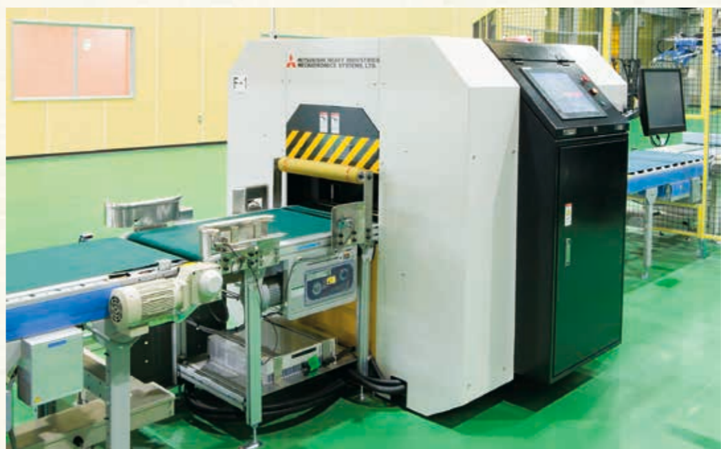
▲プラスチックシンチレーション検出器Aタイプ 240袋/時
