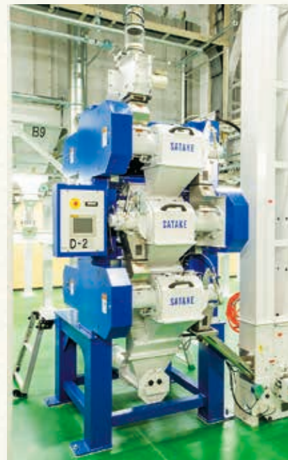
▲精米設備 能力4.0t/時
