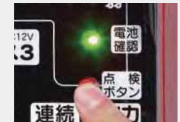
点検ボタンでバッテリーの状態をランプで表示します。
