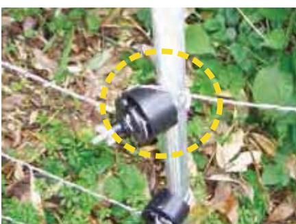
ガイシから柵線が外れ、支柱やガイシの蝶ナット部に触れてしまう事があります。点検の際にはコーナーを重点的にチェックして下さい。
