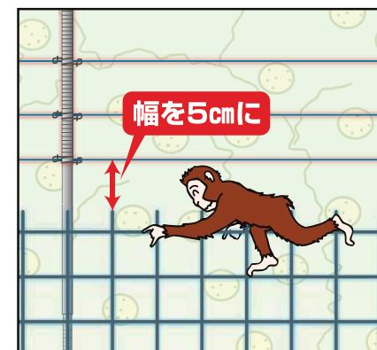
フェンスの上からの侵入を防ぐため、さく線の1段目とフェンスの隙間を5cmにする。
