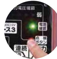
電池の交換時期が分かる電池試験スイッチ付
