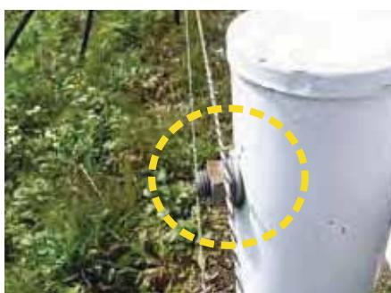
ガードレールやトタンなどの金属に接触すると一気に電圧が下がってしまいます。設置コースを変更して柵線が接触しないようにしましょう。
