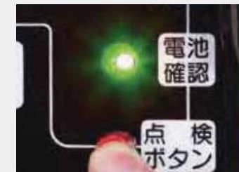
点検ボタンでバッテリーの状態をランプで表示します。
