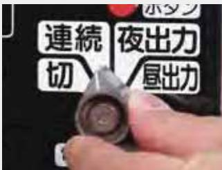
光センサーで周囲の明るさを判別し自動的に作動します。
