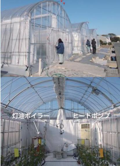
【同型ハウス燃油・電力消費量比較試験】
