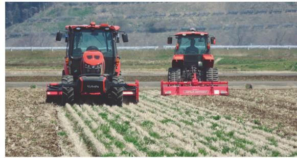
写真1 ロボットトラクタ「MR1000A」(左)と有人機①「MZ655」(右)との協調作業の状況
