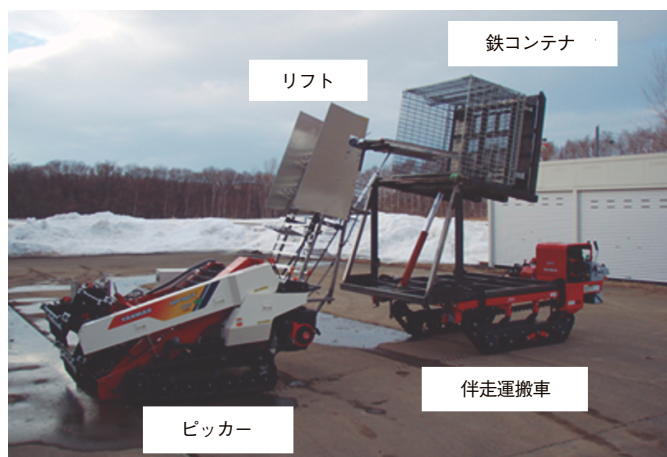
写真1 収穫作業支援機(試作機)の概要(杉戸・2022)
