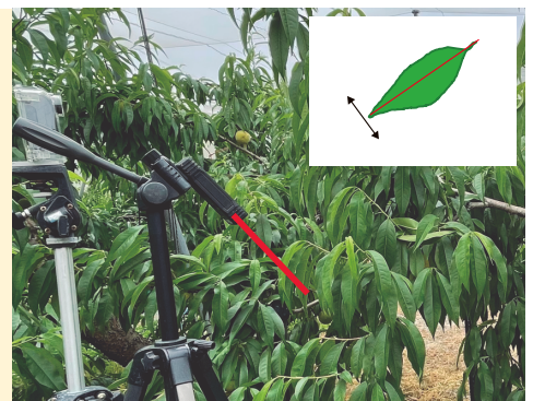
図1 レーザー距離計で葉の萎れを測定(Yamane et al. 2023より改変)
