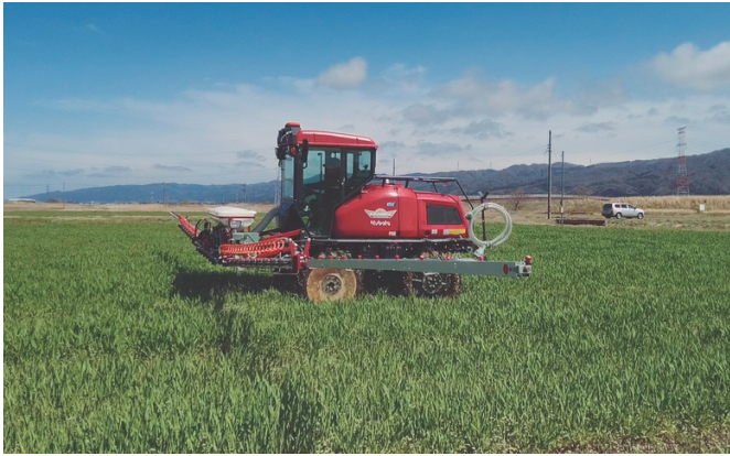
写真1 可変施肥ハイクリブーム(KBSA-651CEG6-SAS)による可変追肥の様子
