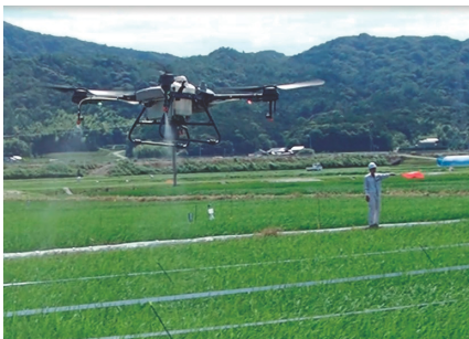
写真1 ドローンによる農薬の空中散布
