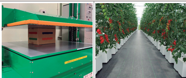
段ボール容器圧縮試験機による段ボール箱強度の計測 「ういずOne」を用いた栽培試験
