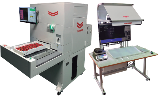
写真2 スマート選果システムの親機(左)と子機(右) 写真3 スマート選果システムの子機アシスト
