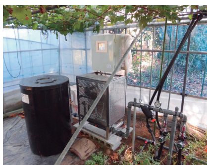
写真2 施肥・かん水が自動化された「養液土耕システム」
