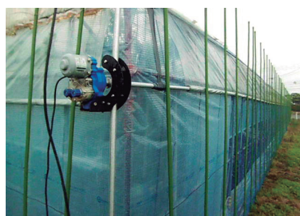
写真1 ハウス側窓の自動開閉ができる「自動換気システム」
