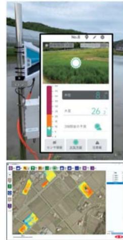
水田の栽培環境(水位・水温など)を計測しスマートフォン等で確認できるセンサー
