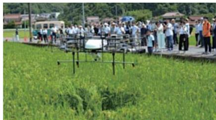
全自動飛行ドローンを用いた水稲のセンシング(生育診断)
