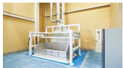
① 荷受ホッパー ラインで精米する原料玄米を張込みます。
