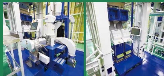
① 荷受ホッパー ラインで精米する原料玄米を張込みます。
