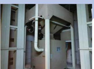
⑦ 酒米の精米は、高白度35%から白度80%と搗精幅が極めて広いため、精米機運転では自動精米機で粒揃いの良い高品質精米機を設置。一方で、少量多品目の高白度精米に的確に対応するため、小型醸造精米機を設置します。
