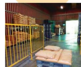
⑫ 一連の精米工程を終えた精米は、お客様のご要望に合わせ、30kg紙袋と60kgフレコンに自動計量包装します。
