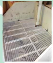
③ ピアノ線と網線により玄米粒以上以下の異物を取り除きます。
