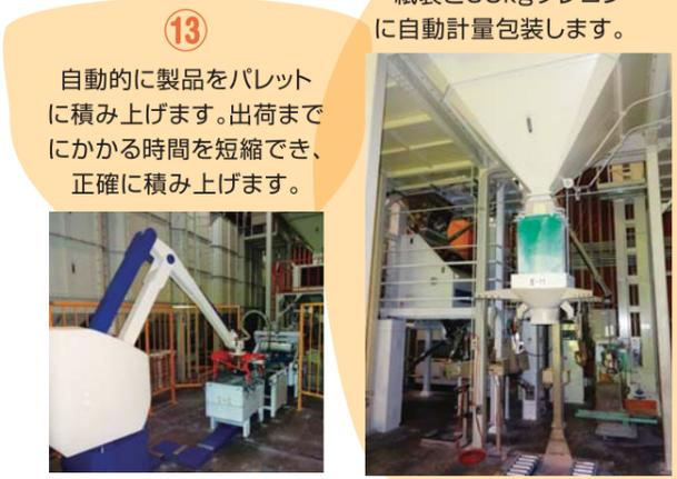
⑬ 自動的に製品をパレットに積み上げます。出荷までにかかる時間を短縮でき、正確に積み上げます。
