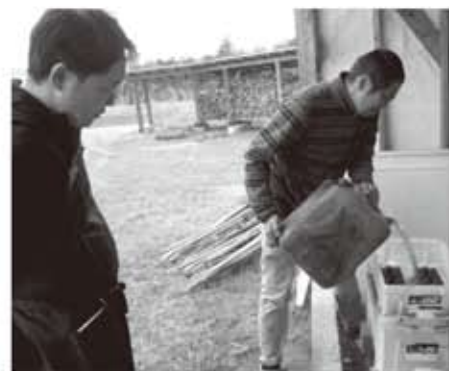
▲レストランから回収した天ぷら油を手製のろ過機(ティッシュペーパー使用)でろ過。「この作業が一番大切。仲間内では(お高め)の料亭や蕎麦屋の廃油が評判が良い。とんかつで使った廃油はラードで固まってしまうとのこと。」
