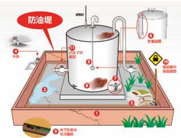
オイルタンク点検の主なポイント
