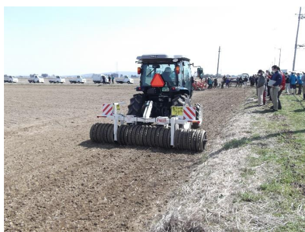
【ケンブリッジローラーによる鎮圧】
