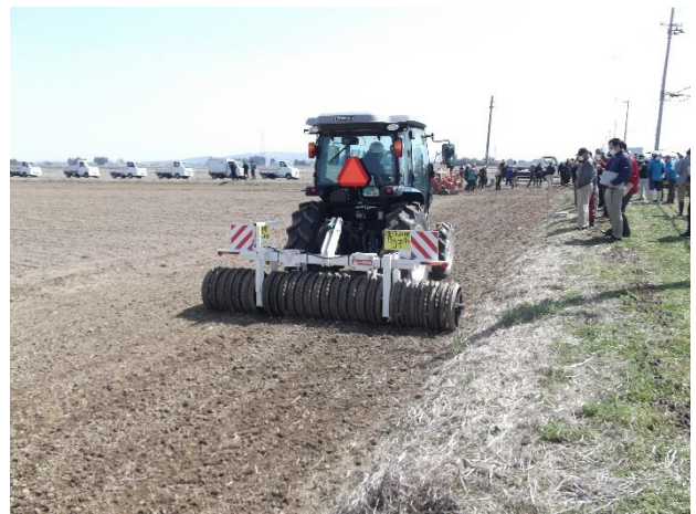
【ケンブリッジローラーによる鎮圧】
