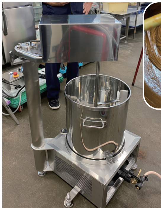
国内初のブラウンチーズ製造機。ガスで加熱しながら攪拌する
