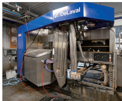
搾乳ロボットに付設したハードナビゲーターが乳汁中のプロジェステロンを測定し発情を発見する
