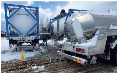
タンクローリー（写真右車両）から、コンテナタンク（写真左奥）へ水を移し替えている（補充している）。コンテナの水は酪農家が随時、給水していく。
